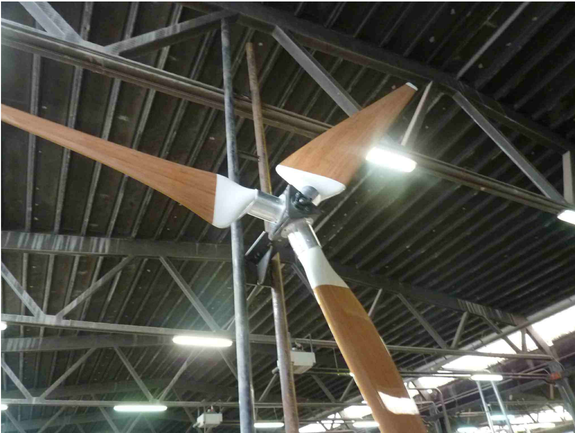
Figura 2: Rotore eolico in materiale biocomposito premontato in officina
